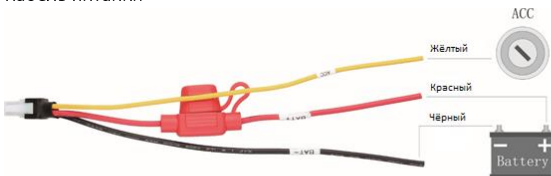
рис. 6 – внешний вид кабеля питания, подключение к бортовой сети ТС
