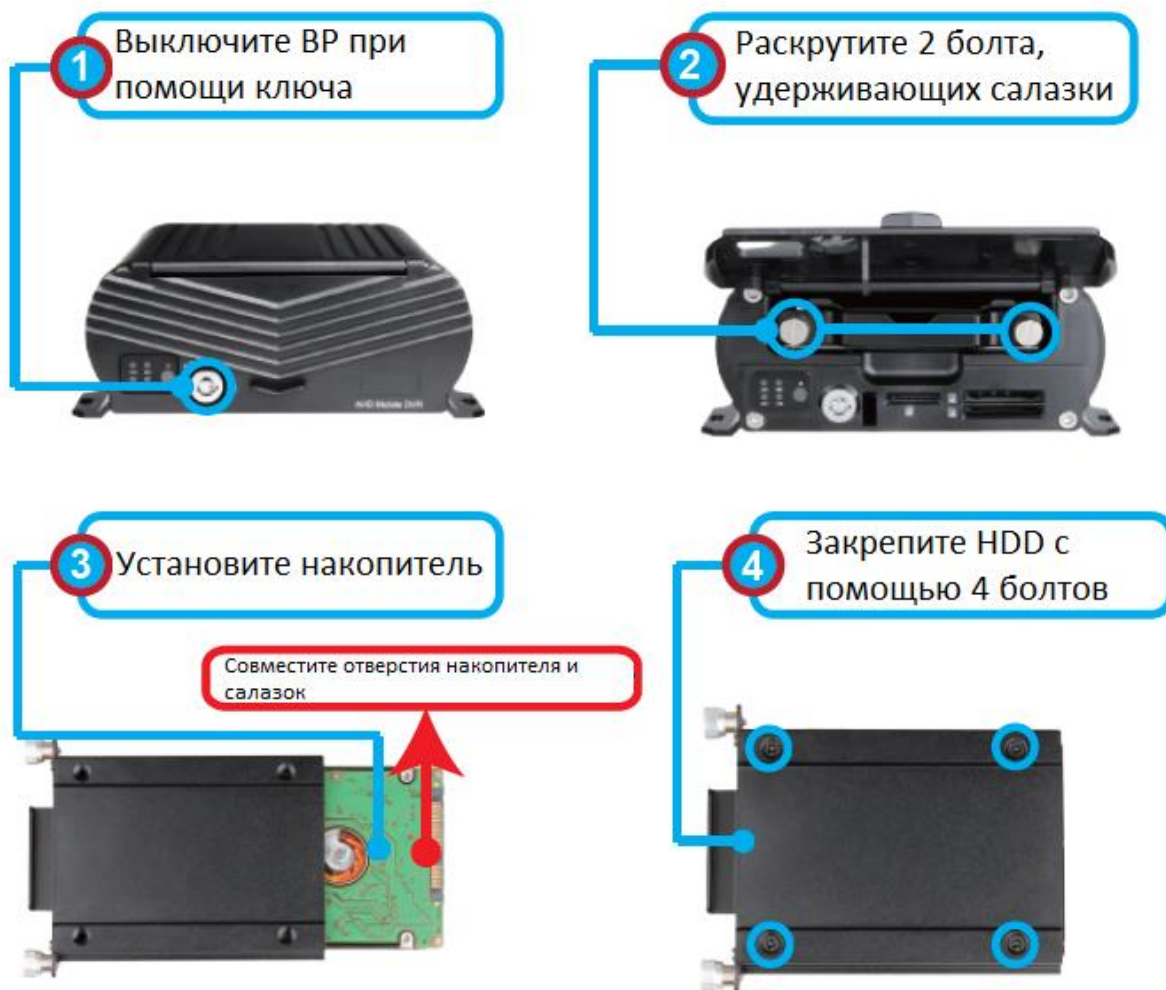
рис. 7 – установка жёcткого диска в видеорегиcтpатор. После сборки аккуратно установите салазки внутрь ВР.
