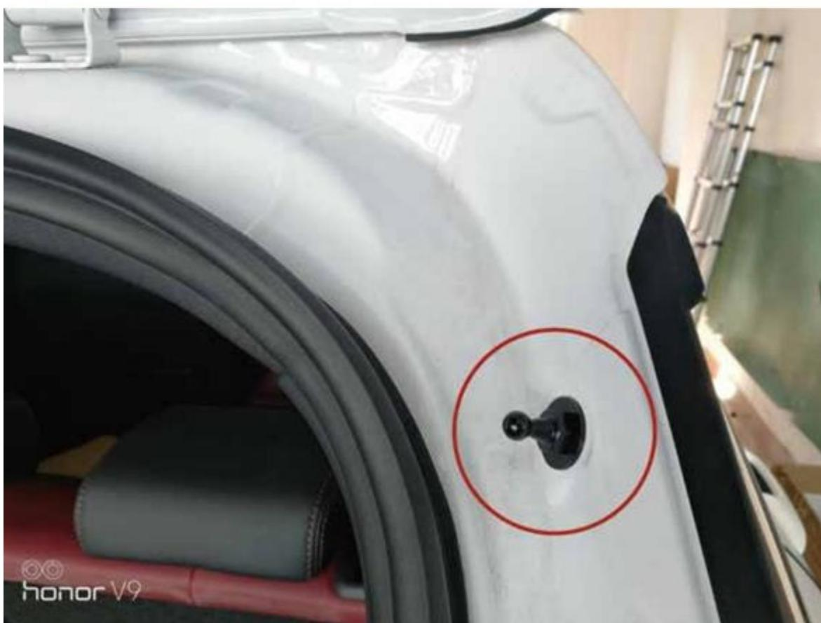
3. Снимите оригинальные стойки двери багажника, и замените штатные шаровые опоры шаровыми опорами из комплекта.
