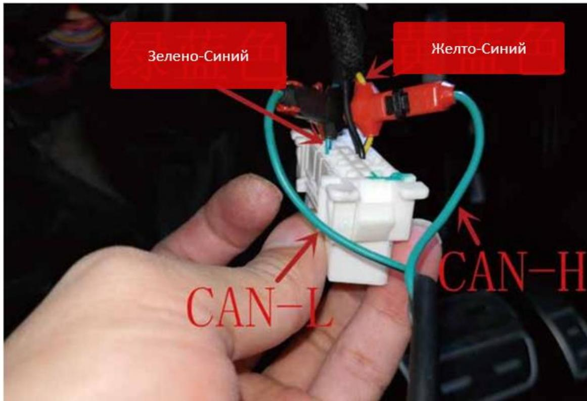
13. Найдите оригинальный разъем OBD автомобиля под приборной панелью, прикрепите нашу линию CAN-L к зелено-синей линии OBD, а линию CAN-H к желто-синей линии, как показано на рисунке
