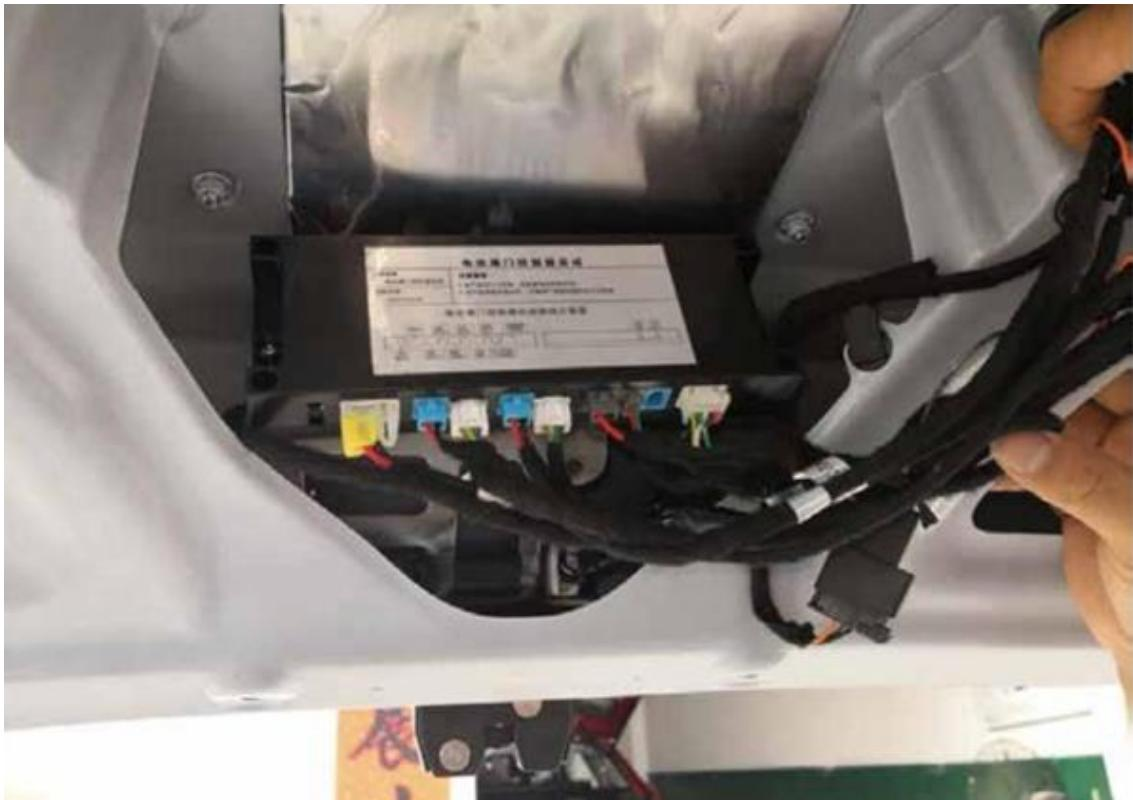
14. Закрепите блок управления на кронштейне винтами и подключите соединительные провода, как показано на рисунке
