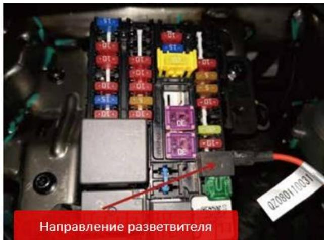
11. Найдите блок предохранителей авто под приборной панелью и вставьте кабель питания. Обратите внимание на направление электроприбора, как показано на рисунке
