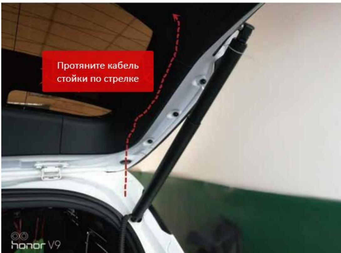
6. Установите опорную стойку (L-левый, R- правый), обратите внимание на пружинную защелку крышки шаровой головки, которая должна быть зафиксирована на месте, иначе стойка упадет. Протяните кабель как показано на рисунке.
