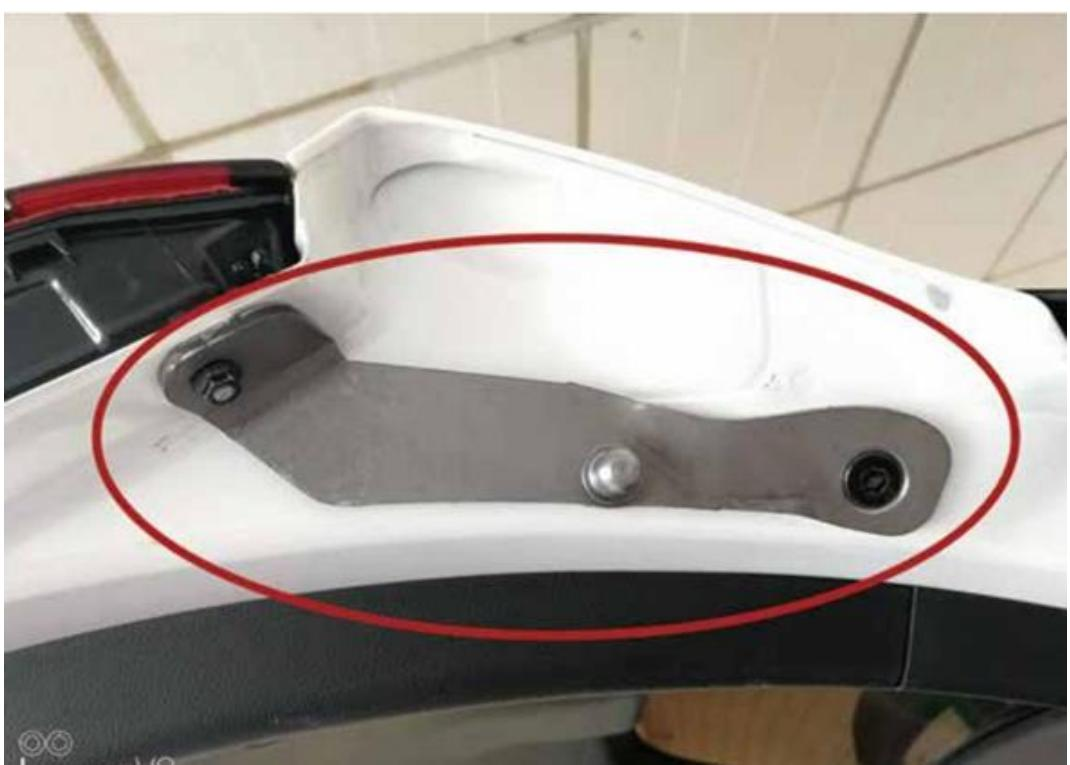
5. Снимите оригинальный кронштейн двери багажника и замените его кронштейном из комплекта, слева и справа. Используйте болты из комплекта.
