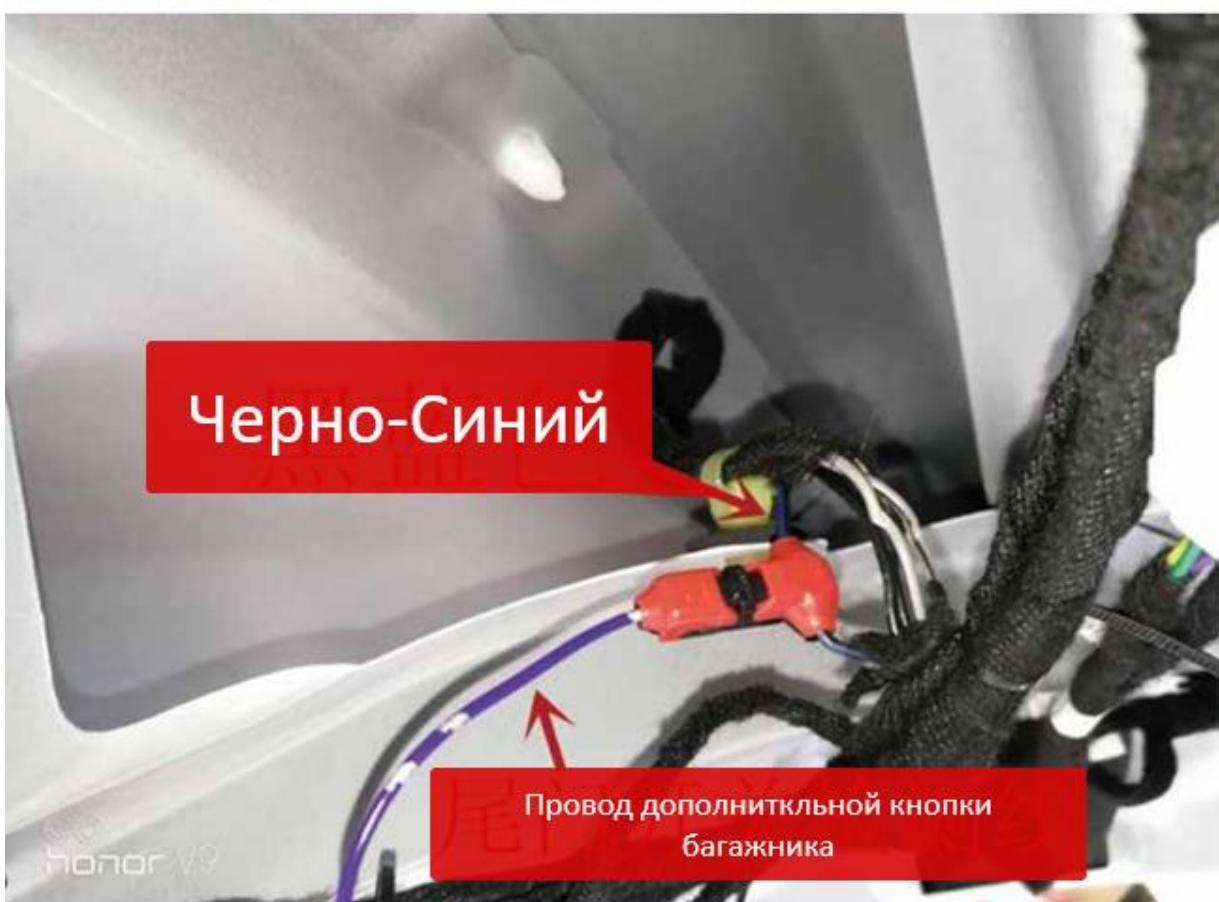
9. Закрепите провод кнопки двери багажника (фиолетовый провод) на черно-синем проводе оригинального жгута проводов кнопки двери багажника, как показано на рисунке
