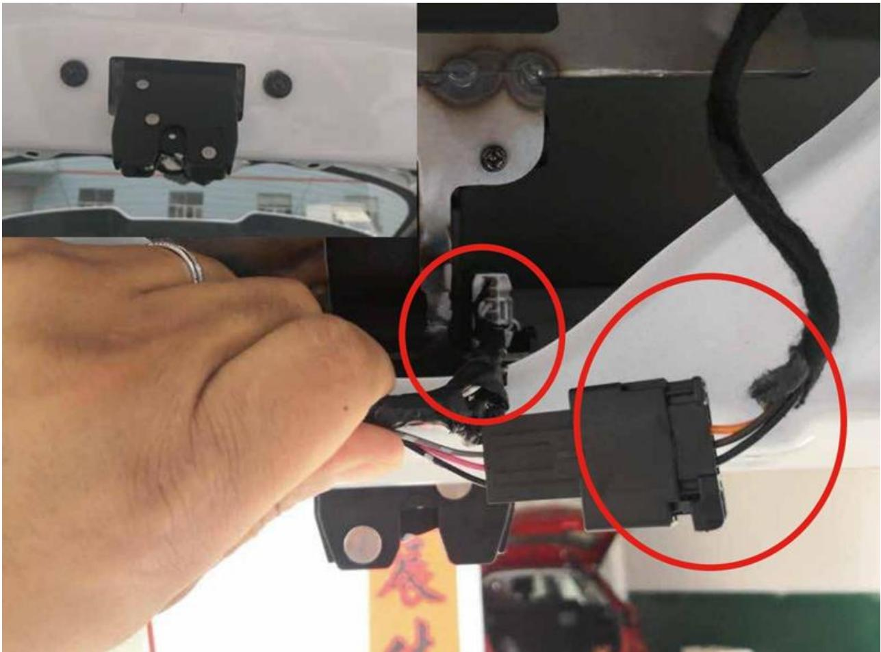
8. Снимите оригинальный автомобильный замок, замените его замком с доводчиком из комплекта и подключите вилку оригинального замка с помощью кабеля адаптера с задней кнопкой, как показано на рисунке.
