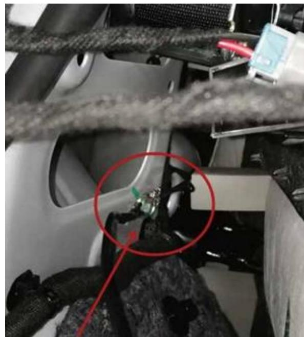
12. Найдите оригинальный провод заземления автомобиля на левой стороне багажника, как показано на рисунке. Подключите заземляющий провод привода
