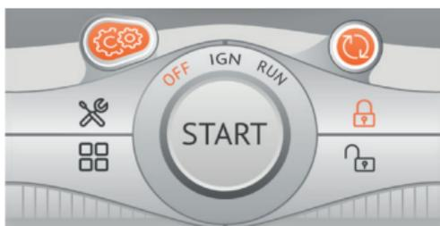
Отправка команды на запуск двигателя будет подтверждена вибрацией смартфона (если разрешено в настройках). Индикаторы «IGN» и «RUN» последовательно загорятся оранжевым светом. Таймер обратного отсчета времени до выключения двигателя будет отображаться на кнопке «STOP».
