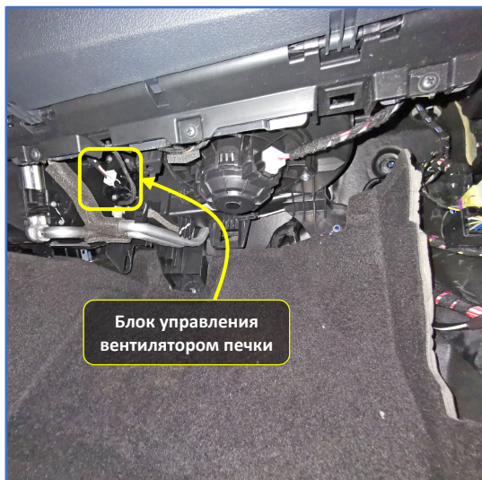
Рис. 1.3. Места подключений справа за перчаточным ящиком
