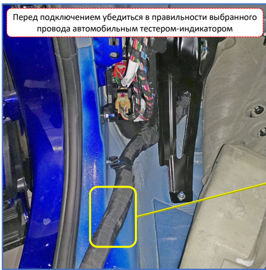
Рис. 3.3 и 3.4. Жгут проводов в водительском пороге
