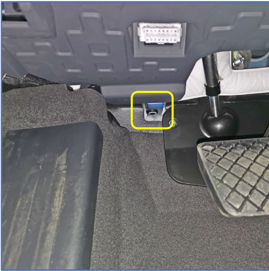
Рис. 8. Возможное место размещения кнопки «VALET»
