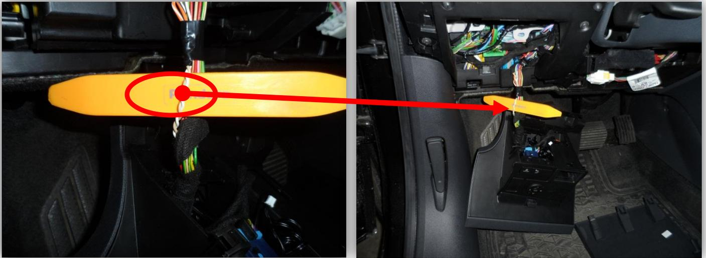
Наиболее удобное место подключения к CAN-шине - витая пара в жгуте блока аварийного запуска под кнопкой start/stop.
