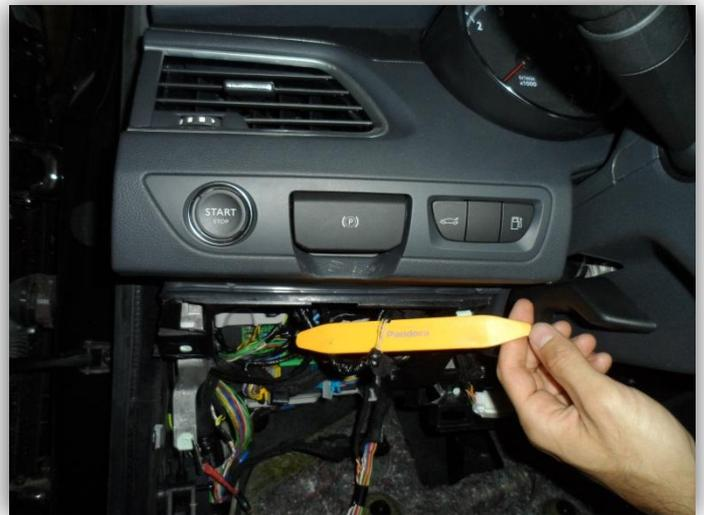
Подключение кнопки Start/Stop, производится в жгуте самой кнопки, на желтый и бежевый провод через диоды подать импульс «+12В». Канал управления кнопкой START/STOP сигнализации Pandora DXL3900 CH2.
