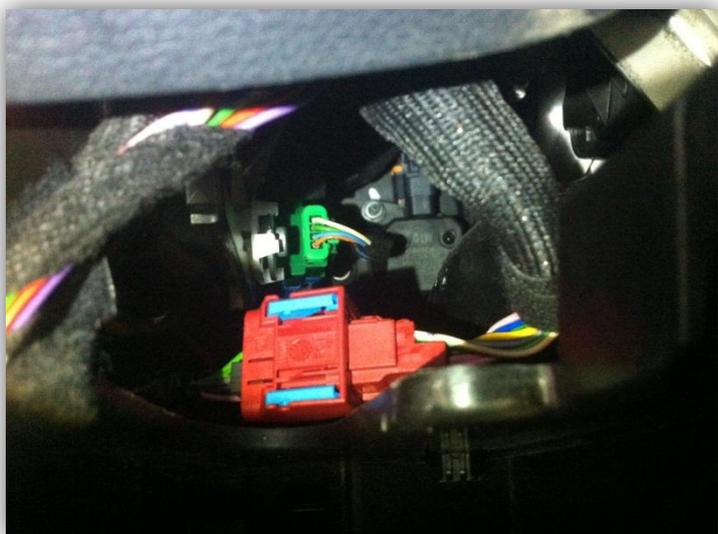
Для имитации нажатия педали тормоза подать «+12В» на зеленый провод контакт 2, разъема датчика педали тормоза. Канал управления датчиком педали тормоза сигнализации Pandora DXL3900 CH3.
