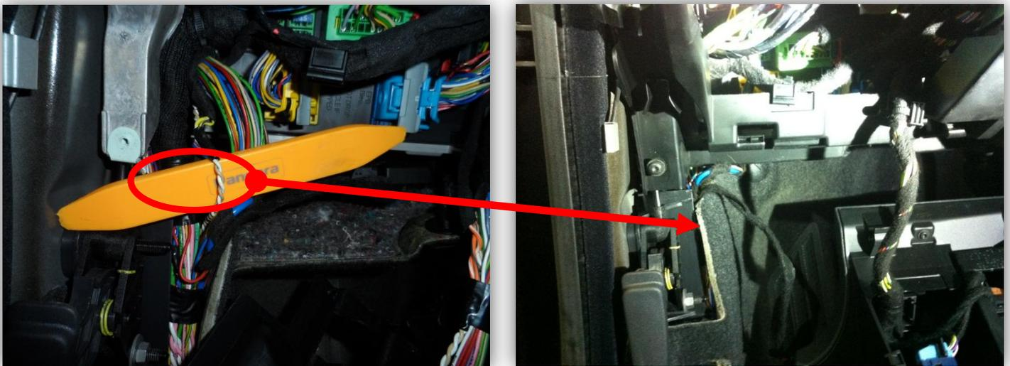
Наиболее удобное место подключения к CAN-шине - витая пара в жгуте идущего в порог водителя.
