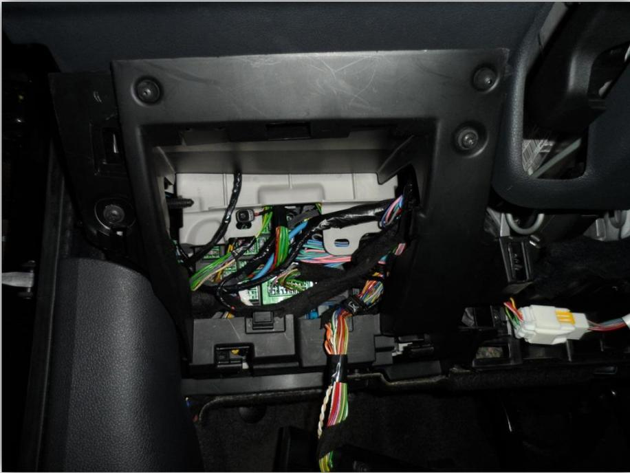
Под рулевой колонкой снимаем пластиковую панель.
