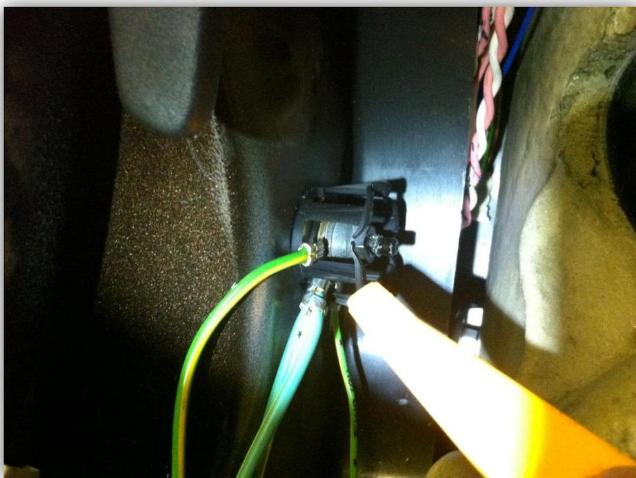
Наиболее удобное место подключения к шатному болту массы расположенного в кик панели водителя.
