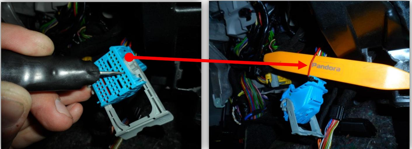
Провод кнопки аварийной световой сигнализации подключается в синем разьеме блока BSI контакт 7, красный провод. Канал управления кнопкой аварийной сигнализации Pandora DXL3900 CH5.
