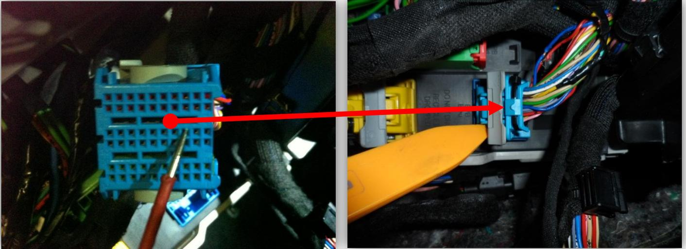
Провод кнопки управления ЦЗ сигнализации подключается в синем разьеме блока BSI контакт 33, желтый провод. Канал управления кнопкой центрального замка сигнализации Pandora DXL3900 CH6.
