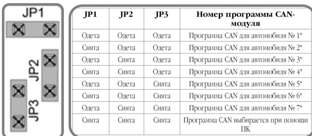
Рис. 1: Перемычки под крышкой центрального блока
