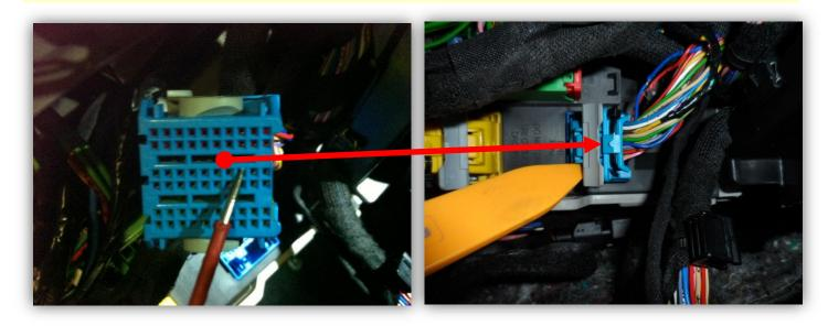
Провод кнопки управления Ц3 сигнализации подключается в синем разъеме блока BSI контакт 33, желтый провод. Канал управления кнопкой центрального замка сигнализации Pandora DXL3900 CH6.
