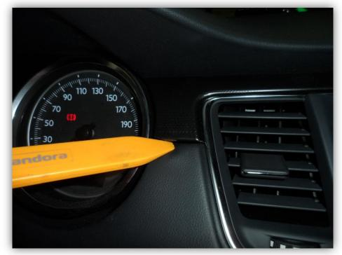
Для размещения базового блока, снимаем приборную панель, за пластиковой декоративной панелью находятся болты крепления.
