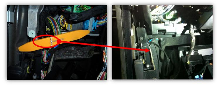
Наиболее удобное место подключения к CAN-шине - витая пара в жгуте идущего из коричневого разъема блока BSI.
