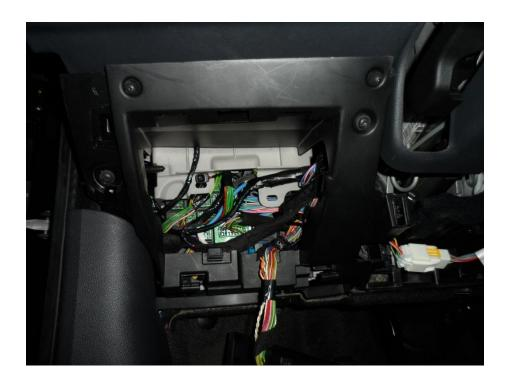
Под рулевой колонкой снимаем пластиковую панель.
