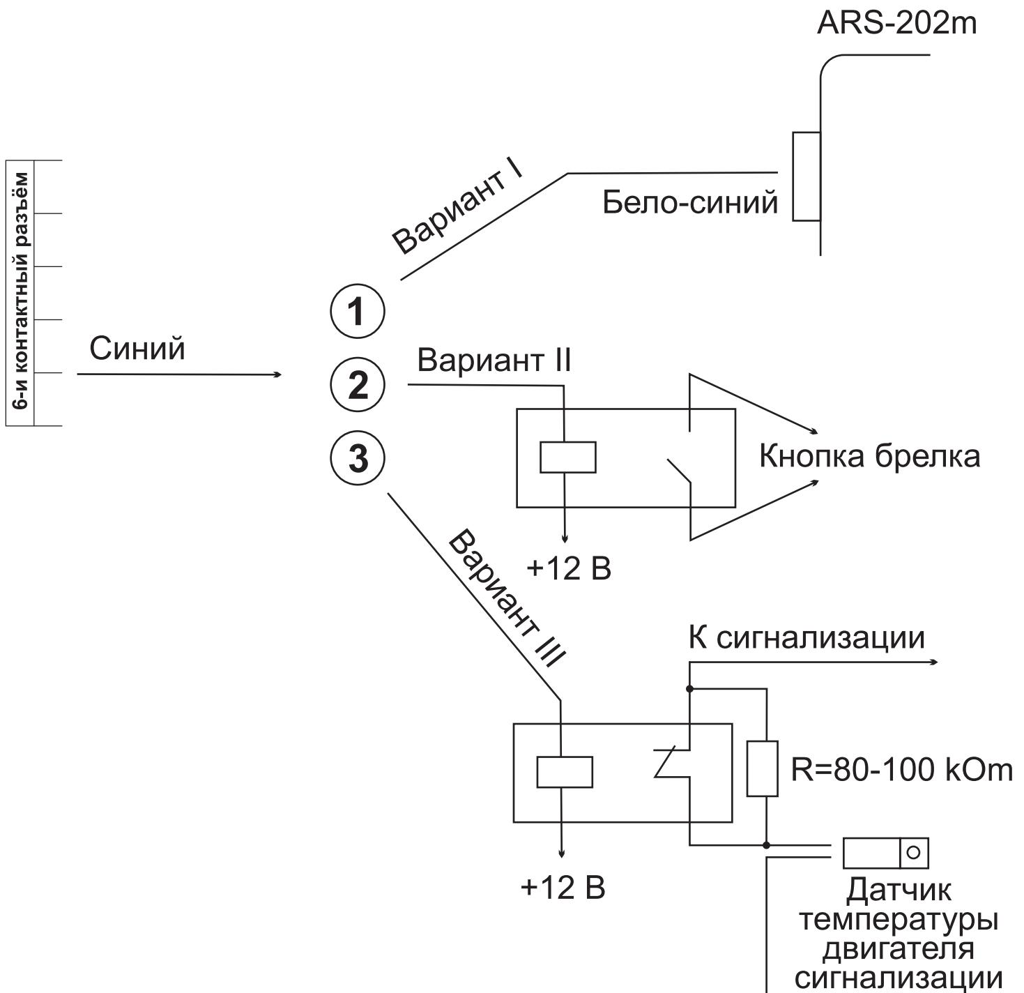
1. Если сигнализация или устройство АДЗ имеет отдельный вход команды пуска, подключите к нему этот провод по схеме «Вариант I» (например, у Absolute ARS-202 бело-синий провод). После получения устройством SOBR-GSM команды 123, на данном выходе появится секундный импульс отрицательной полярности (длина импульса настраивается функцией №20 от 1 секунды до 23 часов 59 минут 59 секунд).
