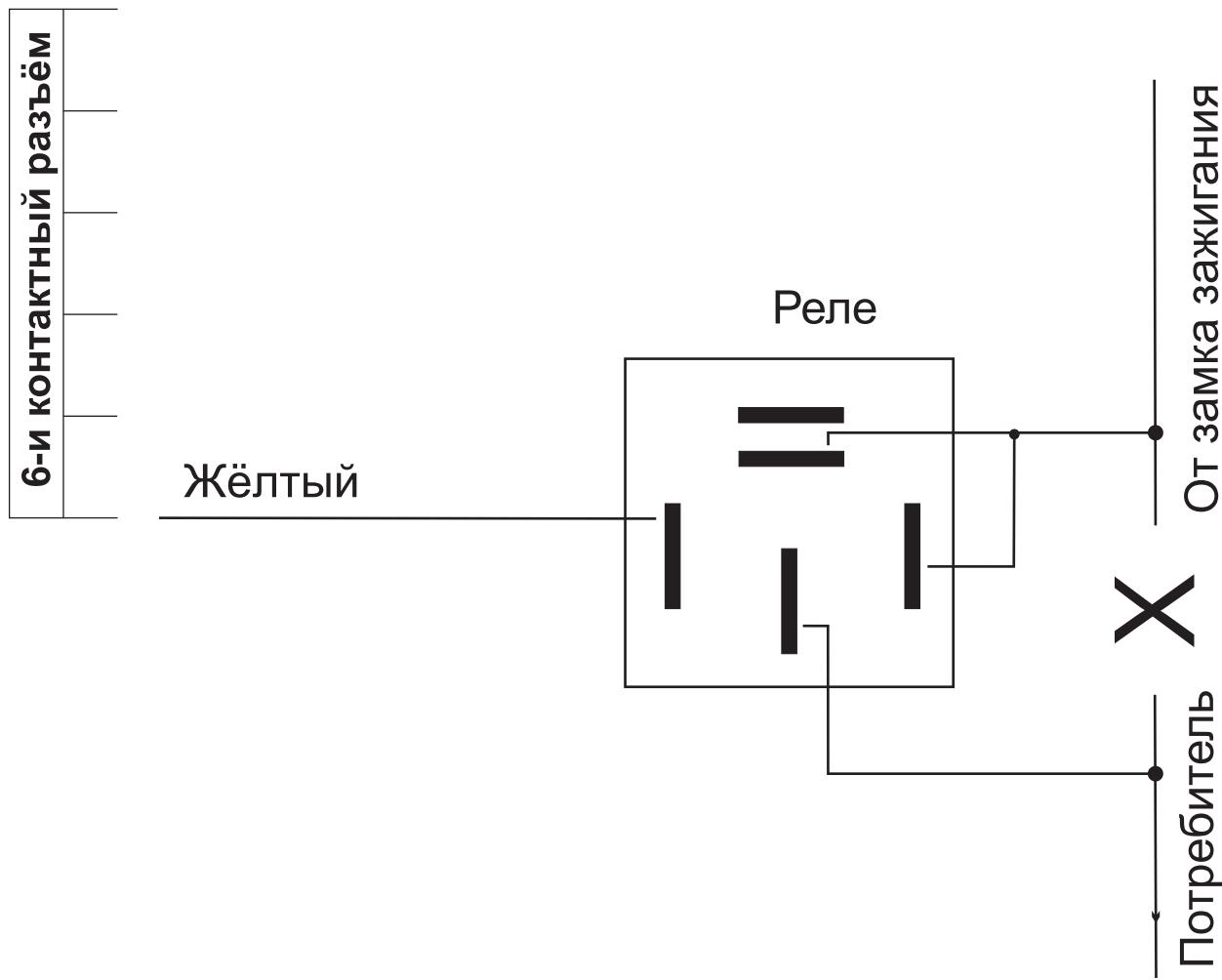
Подключите к этому проводу реле блокировки, согласно схеме. Блокируемая цепь может быть цепью бензонасоса, питания форсунок и т.п., но не стартера. Используются нормально замкнутые контакты реле. Разрыв цепи должен приводить к остановке работающего двигателя, без последствий для дальнейшей эксплуатации.
