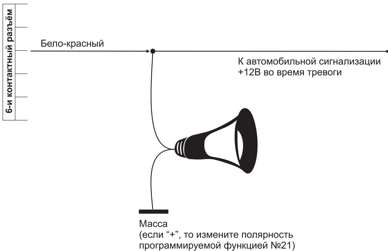
Если подать на этот провод +12 Вольт, устройство звонит на телефон владельца и сообщает «Сработала автомобильная сигнализация». После пропадания +12 Вольт, устройство в течение 30 секунд не реагирует на этот вход. Далее переходит в режим ожидания, и если подать +12 Вольт, будет звонить опять.
