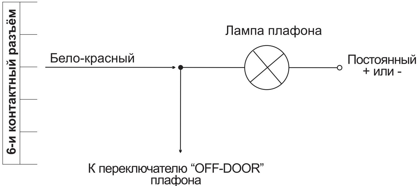
Существует другой вариант подключения данного входа – к лампе плафона освещения салона автомобиля. Этот вариант не зависит от автомобильной сигнализации. Провод необходимо подключить к цепи, идущей от лампы к выключателю «OFF-DOOR» плафона. В положении «OFF», при открывании двери на этом проводе потенциал не должен меняться, и устройство не будет звонить. В положении «DOOR», после открывания двери на этом проводе должно происходить изменение потенциала.
